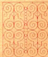
Rejas de hierro forjado (espiral)
